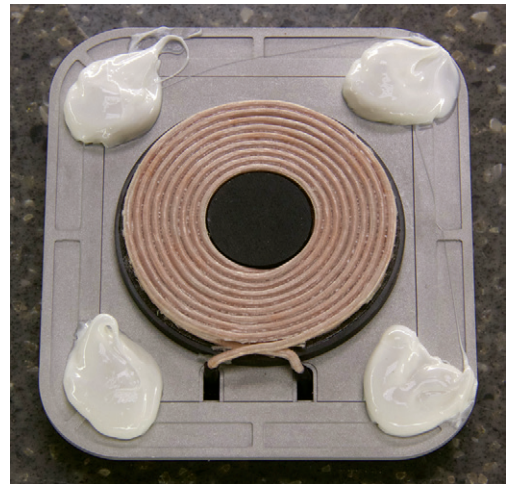
Abbildung D-2: 100-prozentiger Silikonkleber wird auf den Sender aufgetragen
