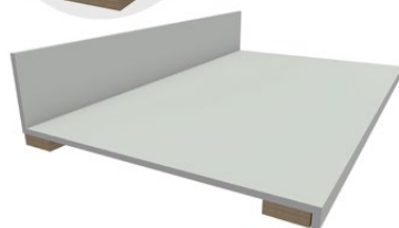
Gerade aufgesetzter Wandanschluss
